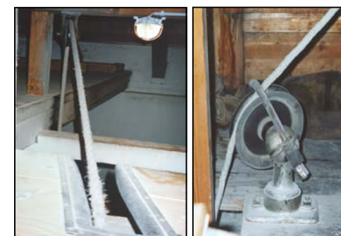
Bilder 10 + 11: Umlenkrollen und Aussparungen verhindern, dass das Steuerseil eingeklemmt werden kann.
