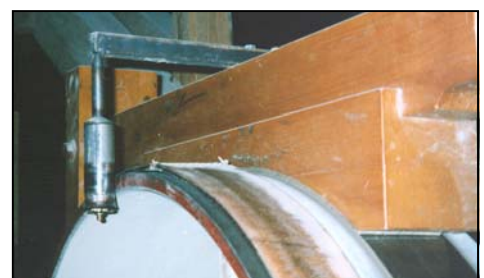
Bild 9: Seitliche Führungsrolle, die das Wegrutschen des Antriebsriemens verhindert. (evtl. notwendig in kalten Gebäuden)
