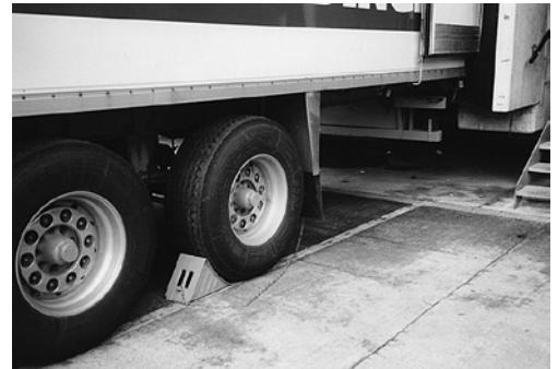
6 Befindet sich ein Keil unter dem Rad, so kann das Ladepersonal sicher sein, dass der Lastwagen nicht wegrollt.
